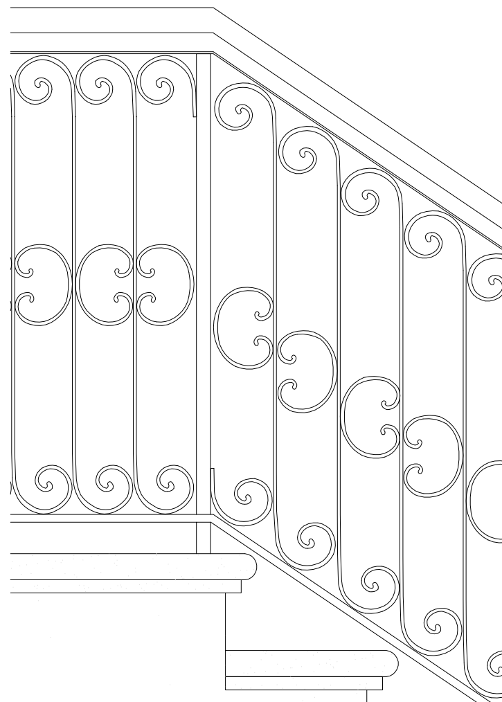
2 DETALHE DO GUARDA-CORPO
