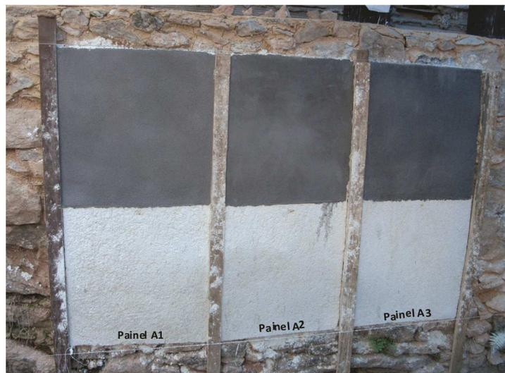
Figura 107: Resultados obtidos nos painéis A após 2 meses (Fonte: FCRB).
